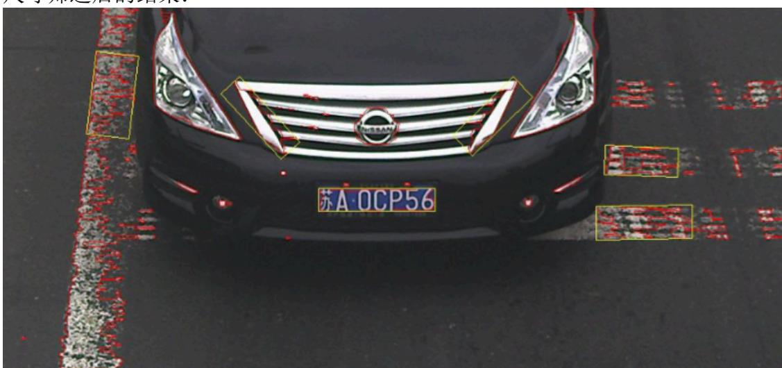
8. 角度判断与旋转。把倾斜角度大于阈值(如正负 30 度)的矩形舍弃。余下的矩形进行微小的旋转，使其水平。最后得到了如下三个矩形：
