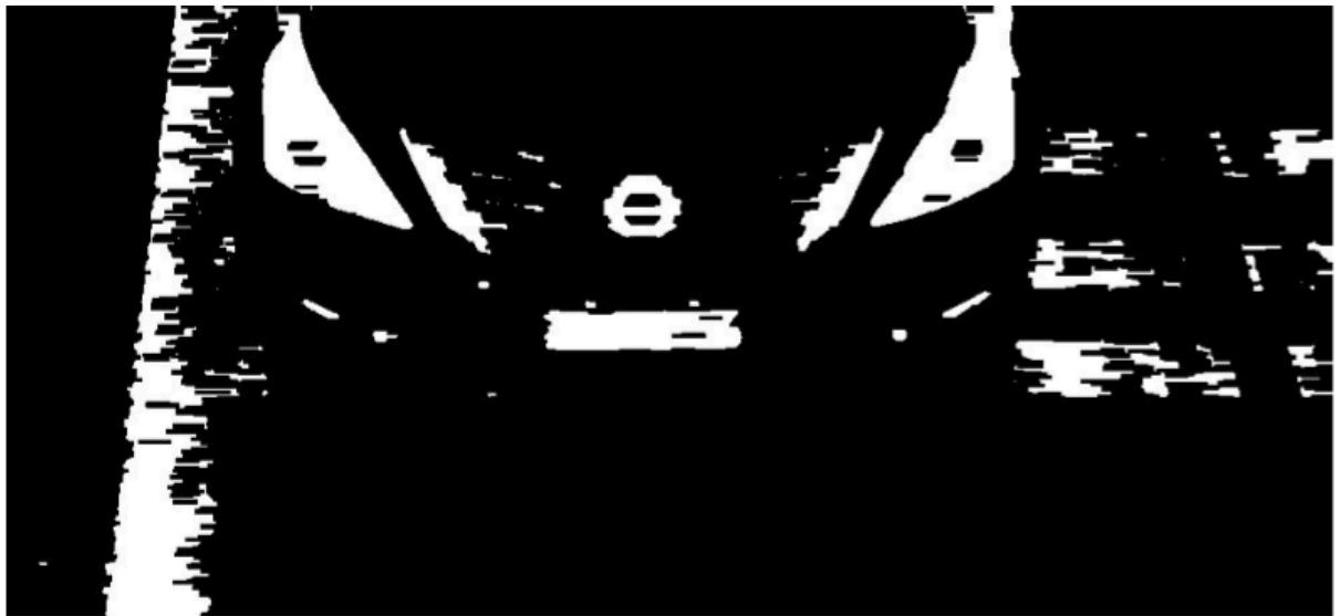
6. 求轮廓（OpenCV 函数 `findContours`）。将连通域的外围勾画出来，以便形成外接矩形（`RotatedRect`）。
