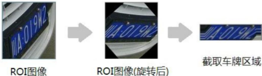
需要首先新建一个尺寸为原始图像 1.5 倍的新图像，接着把原始图像映射到新图像上，于是我们得到了一个显示区域（视框）扩大化后的原始图像。显示区域扩大以后，那些在原图像中没有值的像素被置了一个初值。
