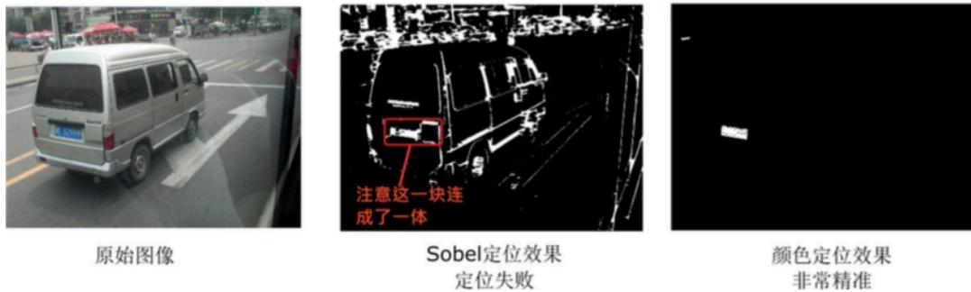
如果将颜色定位与 Sobel 定位加以结合的话，可以使车牌的定位准确率从 75% 上升到 94%。
