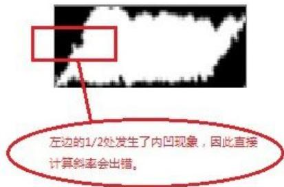
为了实现一个鲁棒性更好的计算方法, 可以用  $(len2 - len1) / Height * 4$  与  $(len3 - len1) / Height * 2$  两者之间更靠近  $\tan(\text{angle})$  的值作为 **slope** 的值 (在这里, **angle** 代表的是原来 **RotataedRect** 的角度)。多采取了一个 **slope** 备选的好处是可以避免单点的内凹或者外凸。
